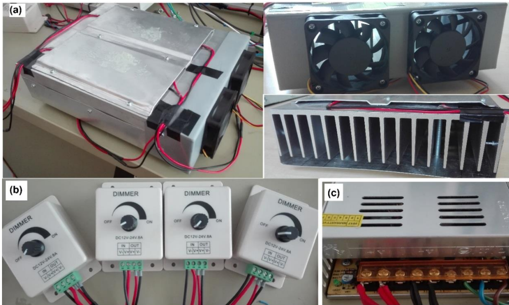
3. ábra. Peltier-elemes hűtőmodul (a), hűtőmodul szabályozó egysége (b) és hűtőmodul tápegység (c).
