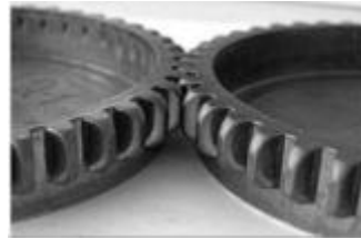
4. ábra. Fogazott lemezalkatrész [6]
