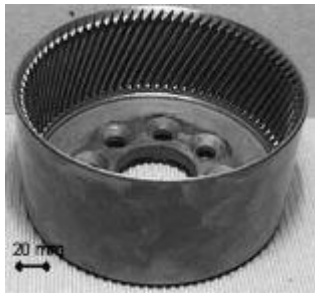
8. ábra. Fémnyomással gyártott külső, illetve belső fogazattal bordázattal rendelkező hengersizmetrikus alkatrészek [10]
