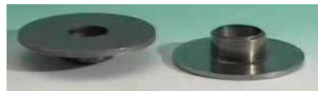
12. ábra. Tárcsaszerű lemezalkatrész középonti persellyel [15]
