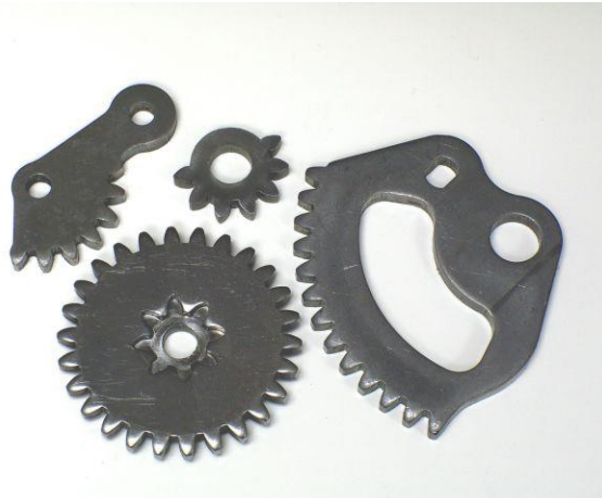
2. ábra. Finomkivágással gyártott, fogazatot tartalmazó lemez alkatrészek
