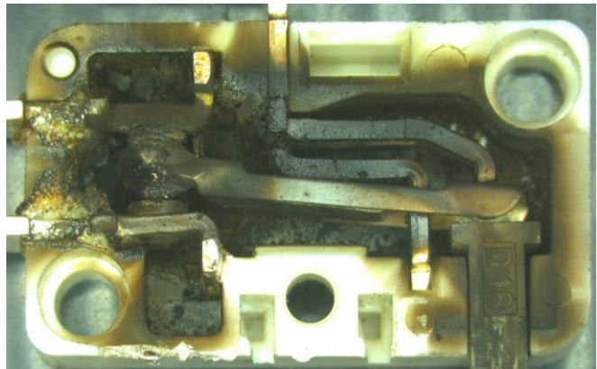
3. ábra. A mikrokapcsoló házának és belső szerkezetének fotója egy részlete 143.213 kapcsolási ciklus után
