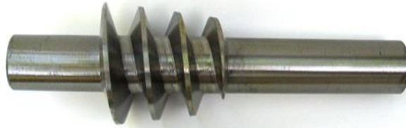
3. ábra. A hengeres lábfelületnek köszönhetően pontosan megköszörülhető archimédeszi kúpos csiga
