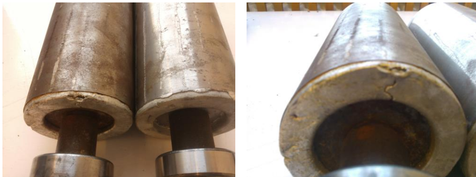
7. ábra. Forgórészek (bal oldali ábra), a hibás forgórész (jobb oldali ábra)
