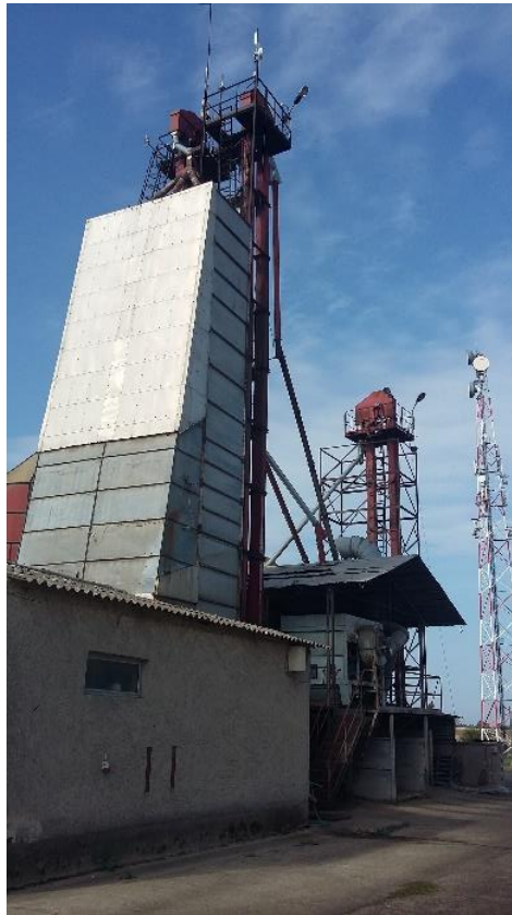
1. ábra. Bábolna 1-15 típusú keresztáramlású gabonaszárító
