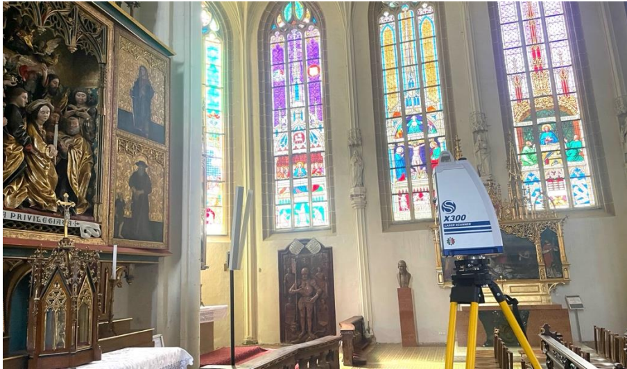
2. ábra. A Stonex X300-as lézerszkennő a szepeshelyi templomban. Forrás: a szerző fotója
