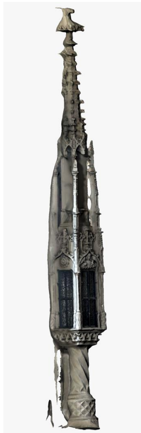
6. ábra. A gölncibányai szentségház Reality Composerrel készült, mérethelyes 3D-s modellje. Forrás: a szerző munkája.
