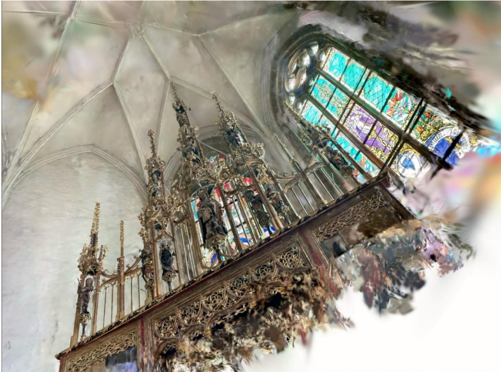
8. ábra. A szepeshelyi oltárkorona fotók alapján készült Gaussian Splat-modellje. Forrás: a szerző munkája.
