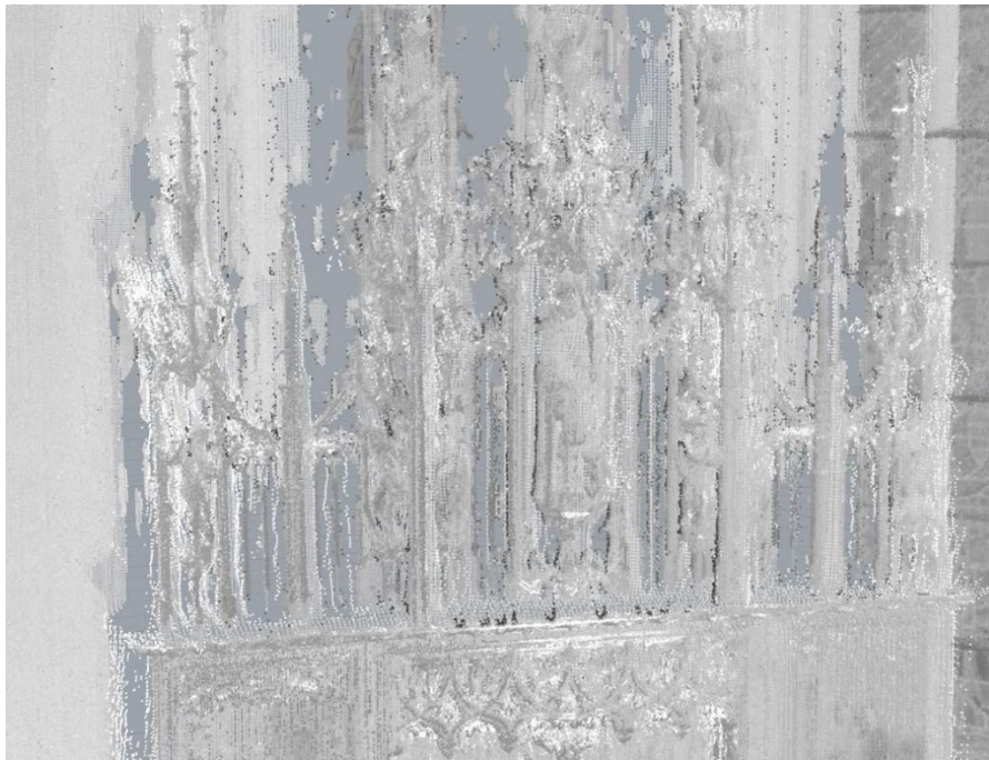
3. ábra. A szepeshelyi oltárkorona Stonex X300-as lézerszkenneléssel, több állásból felvett pontfelhője. Forrás: a szerző munkája.
