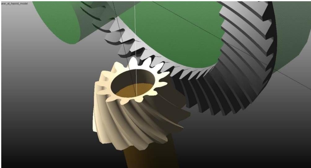
1. ábra. A hipoid fogaskerékpár MSC Adams szimulációs modellje
