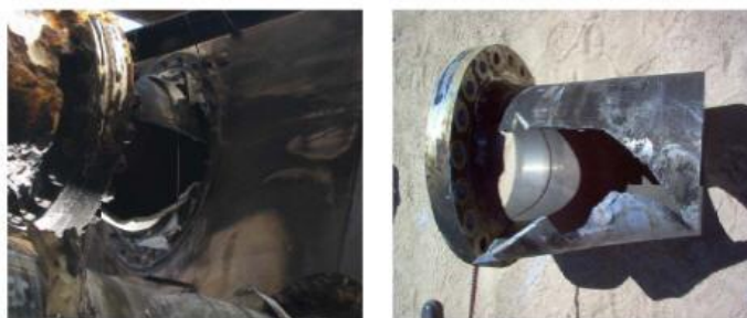
1. ábra Moomba gázelőkészítő üzem felhasadt csomkja [1]
