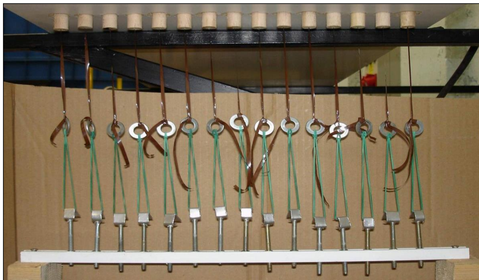
3. ábra. A szalagok fokozatmentes feszítéséhez készített szerkezet.
