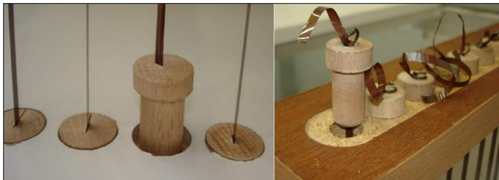
2. ábra. A szalagok stabilizálásához készített elemek a csatorna alján és tetején.
