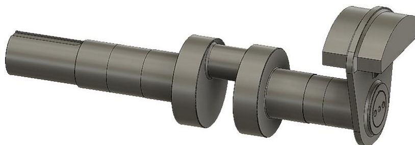
7. ábra. Tengelyvégre szerelt ellensúly forgattyúcsap köszörülési műveleténél.
