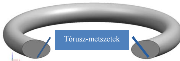
4. ábra. A csúcsgár vagy körlapka által generált elméleti tórusz alakzat, és annak metszése merőleges síkkal
