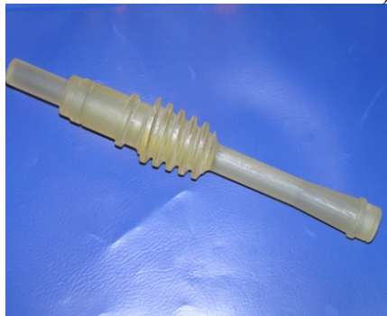
7. ábra. A csigatengely rétegenkénti nyomtatása (a), az elkészült modell támaszanyaggal körülvéve (b) és az előállított csigamodel (c)
