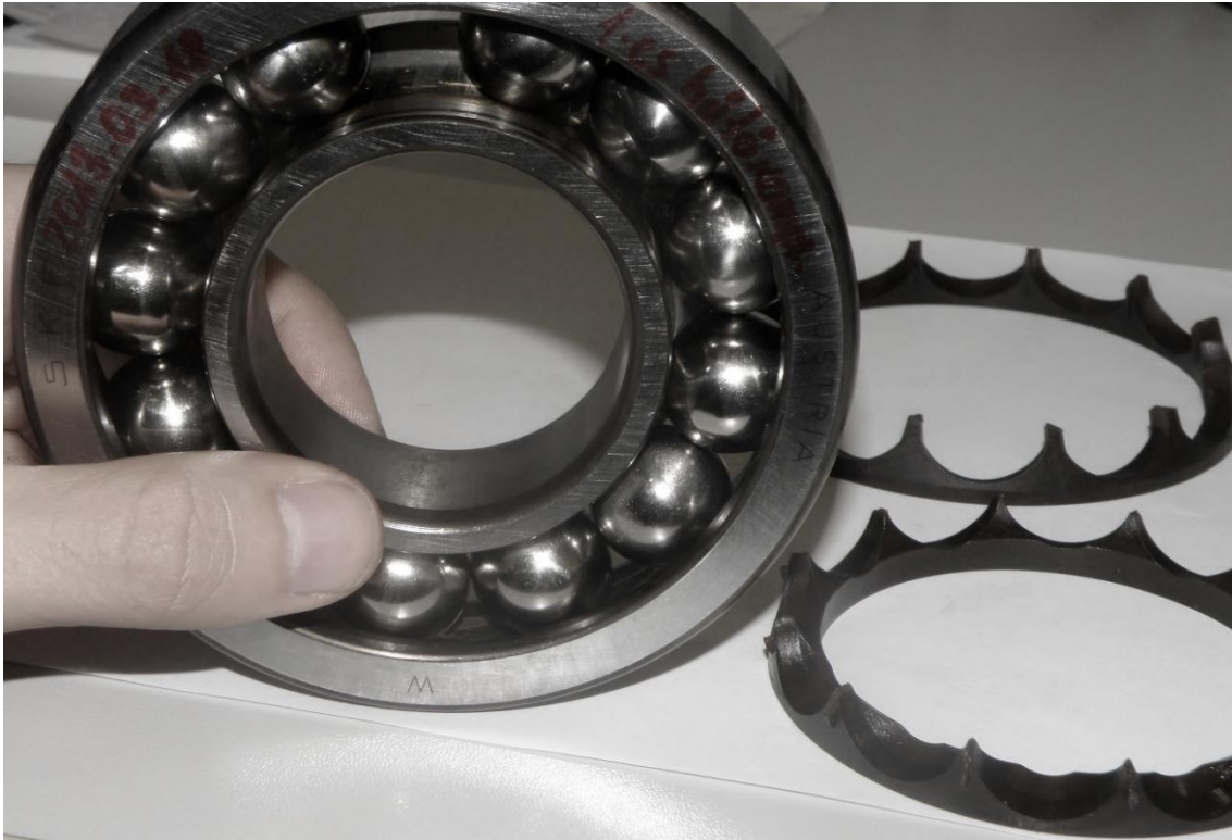
4. ábra. Sérült csapágy a kiszertelés után (Forrás: saját felvétel)
