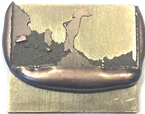
4. ábra. Méretre vágott, arannyal bevont mintadarab.
