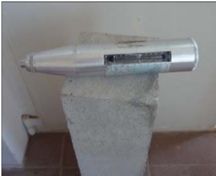
1. ábra. N-típusú Schmidt – kalapács
